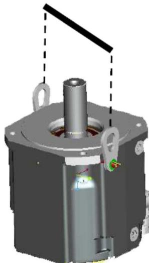
B3/ 2 x LIFTING BOLT PLUS LIFTING BEAM
